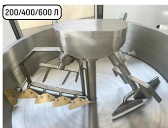
Рис 3. Типы месильных органов.
