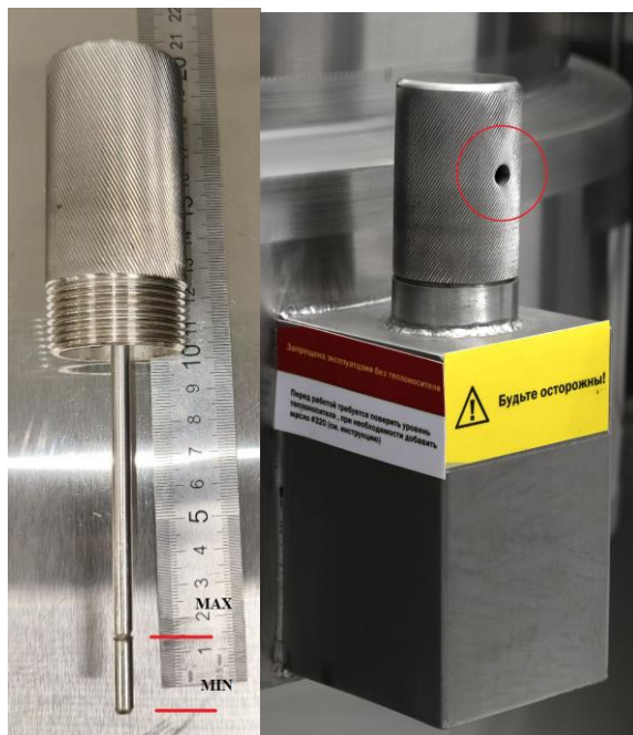
Рис.№8 Отметка уровня теплоносителя на шупе. Вентиляционное отверстие масляной рубашке
